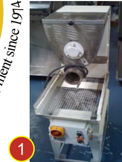
1 La Parmigiana D45 extruder (USED). 16kg/hr approx long or short pasta.
